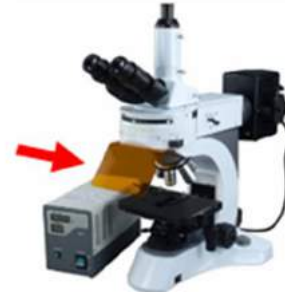
Şekil 8.27: Floresan mikroskop ve UV kalkanı
