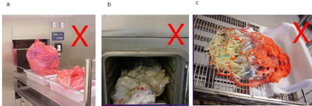
Şekil 12.5: Hatalı otoklavlama örnekleri (açıklama için üstteki metne bkz.)
